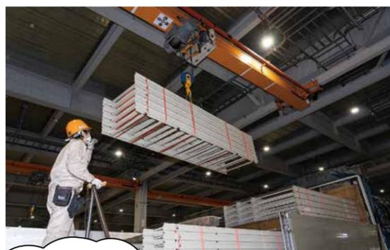
クレーン操作を行い、積み付けシステムの指示どおりに作業します。
