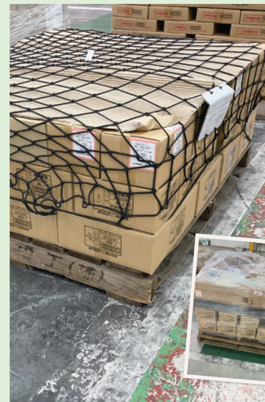
自社でゴムネットとゴムロープを組み合わせて作成。何度も輸送テストを繰り返しました。
